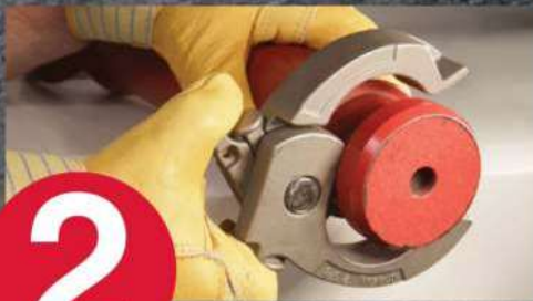
Empuje el collar sobre el perno
